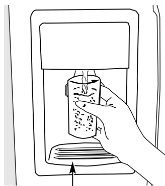
Bac de trop-plein
